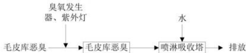
图1-7 毛皮库的恶臭气体处理工艺流程
